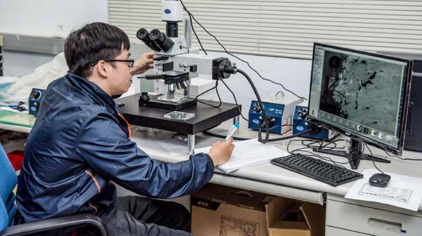
機械工程系金相顯微鏡暨影像系統
