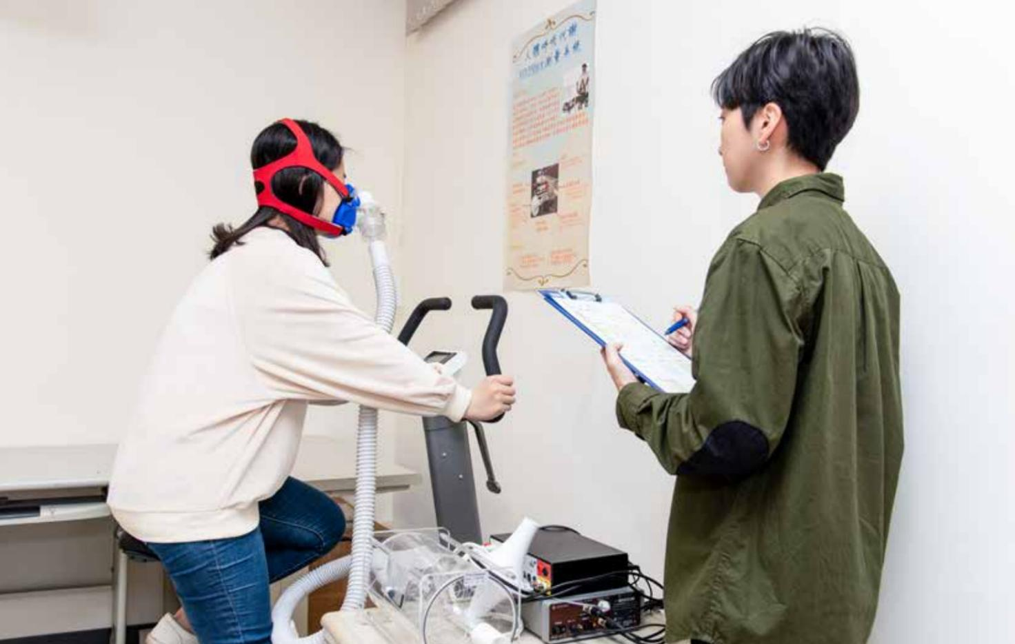
師生使用人體代謝功能評估平台的人體呼吸代謝 VO2 max 測量系統測試運動後氧氣濃度、二氧化碳濃度、肺氣流量及心率進行呼吸代謝等相關生化值
